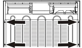
1. Destornillar los tornillos (6 ud.) del condensador y abatir el condensador oblicuamente hacia atrás.
