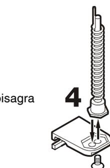
4. Cambiar el eje del soporte de bisagra al lado opuesto.
