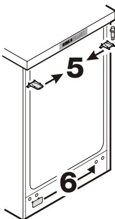
5. Cambiar los elementos de la bisagra superior al lado opuesto.
