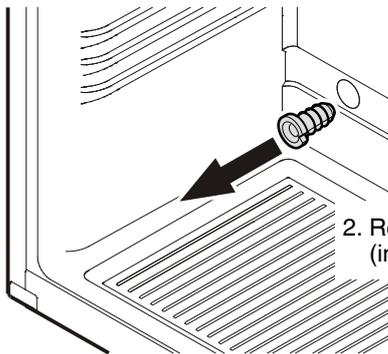
2. Retirar la descarga de tracción (interior, abajo a la izquierda).
