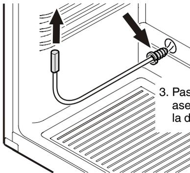
3. Pasar el sensor por la abertura y asegurar el cable del sensor con la descarga de tracción.
