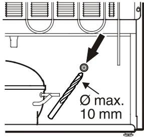
1. Abrir taladrando la posición marcada en la parte posterior del aparato.
